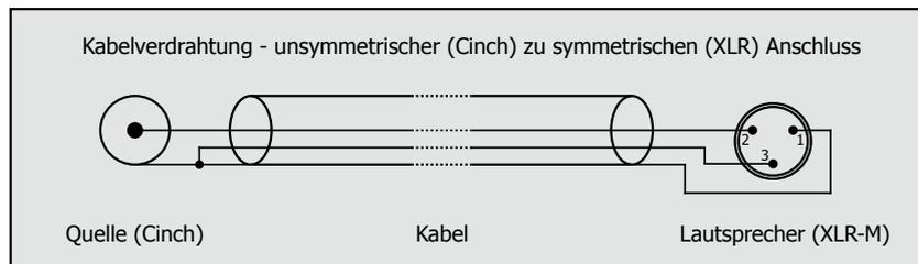
Zum Verbinden des RL-Amplifier mit dem zugehörigen Lautsprecher wird ein NL8 Speakonkabel benötigt, dass entsprechend der nachfolgenden Tabelle verdrahtet ist:
